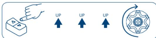
Come si vede nell'esempio, quando la sequenza termina in maniera positiva il motore esegue una singola rotazione lunga.
