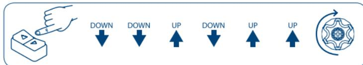
La cancellazione totale dei finecorsa ripristina automaticamente l'impulso corto di regolazione del basculamento lame.
