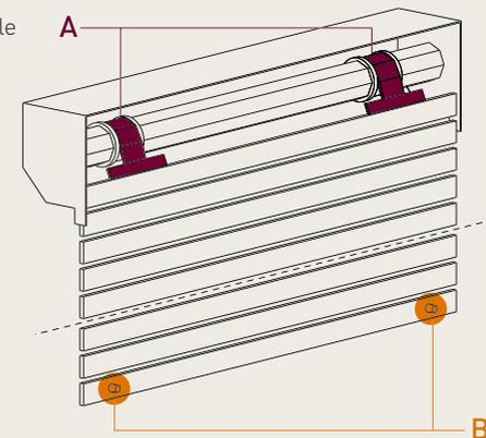
Per il corretto funzionamento sono necessari i blocchi meccanici indicati ai punti A e B.
