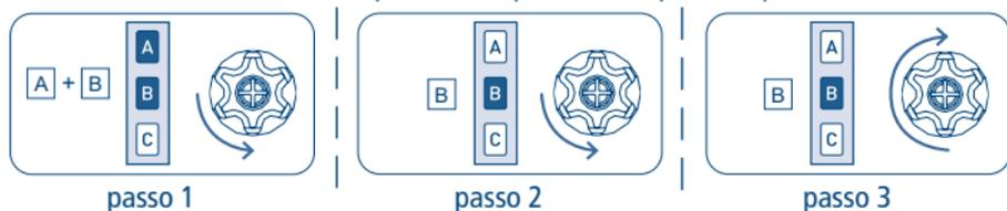
Come si vede nell'esempio, quando la sequenza termina in maniera positiva il motore si riporta nella posizione iniziale con una singola rotazione lunga. Infatti due brevi rotazioni nello stesso senso corrispondono ad una rotazione lunga nel senso opposto. Il motore si riporta nella posizione iniziale anche quando la sequenza non viene completata, in questo caso effettuando una o due brevi rotazioni. Esempi di sequenze incomplete:
