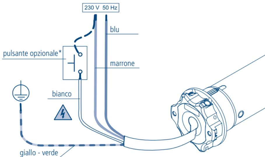
\* L'installazione del pulsante è opzionale, il collegamento può essere eseguito con la fase (filo marrone) o con il neutro (filo blu), indifferente. Con il pulsante è possibile comandare il motore in modalità passo passo (salita, stop, discesa, stop ...).
