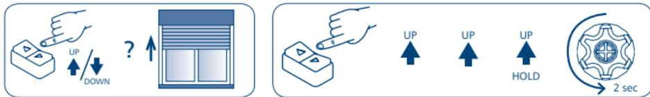
Con il pulsante di discesa della pulsantiera, portare due volte la tapparella in posizione di completa chiusura lasciando che il motore rilevi automaticamente il finecorsa.
