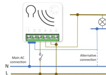
Schema per il controllo di un Carico collegato a un sistema di alimentazione indipendente
