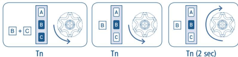
Da questo momento, il motore si muove in modalità "UOMO PRESENTE". Questo permette di eseguire con precisione la regolazione della posizione intermedia aggiuntiva.
