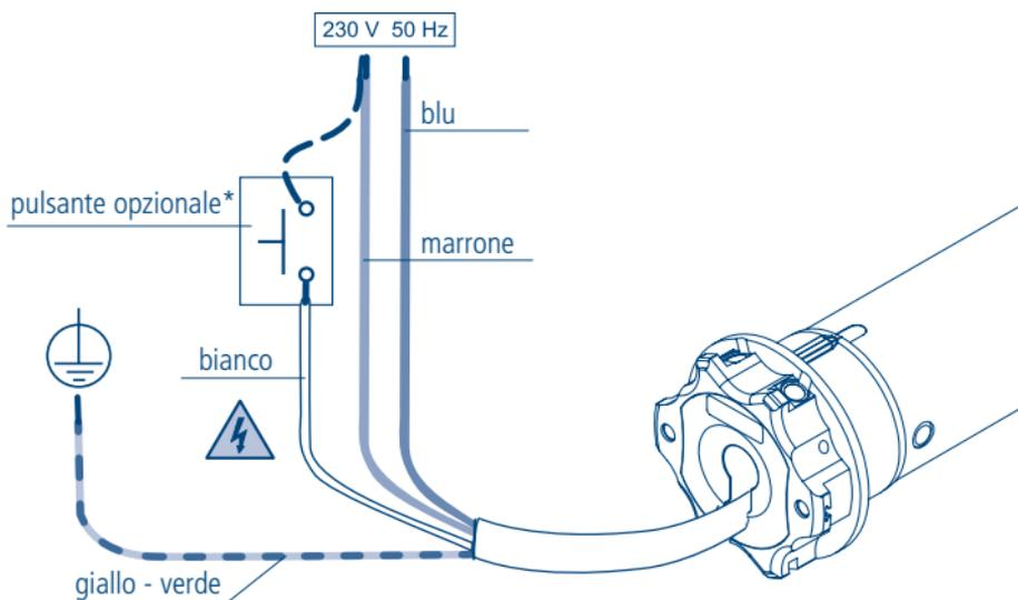
\* L'installazione del pulsante è opzionale, il collegamento può essere eseguito con la fase (filo marrone) o con il neutro (filo blu), indifferentemente. Con il pulsante è possibile comandare il motore in modalità passo passo (salita, stop, discesa, stop ...).
