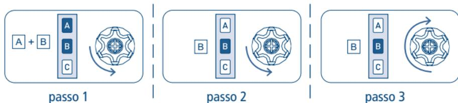
Come si vede nell'esempio, quando la sequenza termina in maniera positiva il motore si riporta nella posizione iniziale con una singola rotazione lunga. Infatti due brevi rotazioni nello stesso senso corrispondono ad una rotazione lunga nel senso opposto. Il motore si riporta nella posizione iniziale anche quando la sequenza non viene completata, in questo caso effettuando una o due brevi rotazioni.
