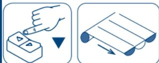
Premendo uno dei due pulsanti e rilasciando, il motore si muove nella direzione desiderata fino al raggiungimento del finecorsa.
