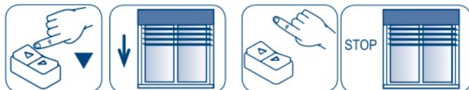
Appuyer sur l'un des deux boutons et relâcher: le moteur se déplace dans la direction souhaitée. Le moteur s'arrête lorsque nous relâchons le bouton ou lorsque le time-out est atteint.
