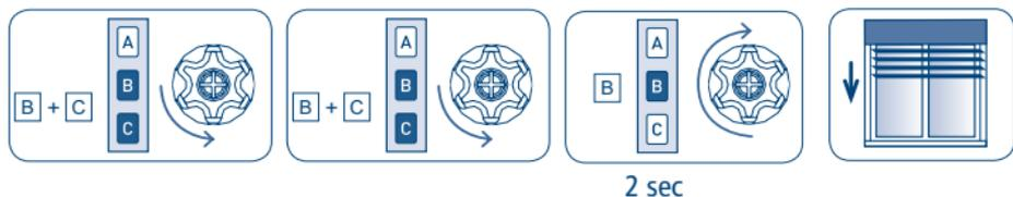
Le moteur se déplace à présent en mode «homme présent», ce qui permet de régler la course de réarmement de la 3e position. Confirmer la course en appuyant sur B (2s). Le BSO descend avec les lames ouvertes en 3e position.
