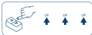
**¡Atención!** Si la secuencia prevé una repetición de comandos iguales (Up+Up/ Down+Down) se necesita interponer la posición Stop si el tipo de inversor lo prevé.
