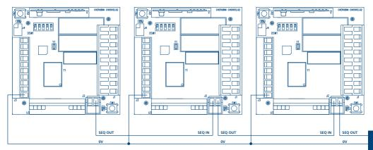
Nota: el mando centralizado se transmite de un módulo Blue Bus a otro a través del BUS de dos hilos Cherubini.
