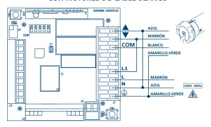
Nota 1: para ver ejemplos de instalación completos, consultar los esquemas incluidos al final del manual. Nota 2: la conexión de salida de L1 sirve para propagar el mando centralizado y las alarmas a través del BUS de 2 hilos Cherubini al final del movimiento del motor.
