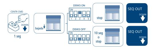
Si durante el movimiento de una orden centralizada se pulsa el botón de la dirección opuesta, el motor se detiene y luego invierte la rotación.
