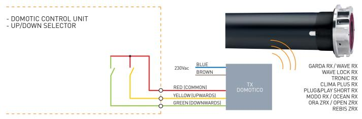
THE DOMOTIC TRANSMITTER IS SET IN THE FACTORY TO WORK IN THE STANDARD MODE.
